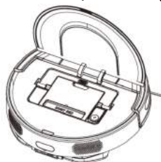
Hình 24. Lắp bình chứa ướt & khô trở lại vào thiết bị và đóng nắp trên.
